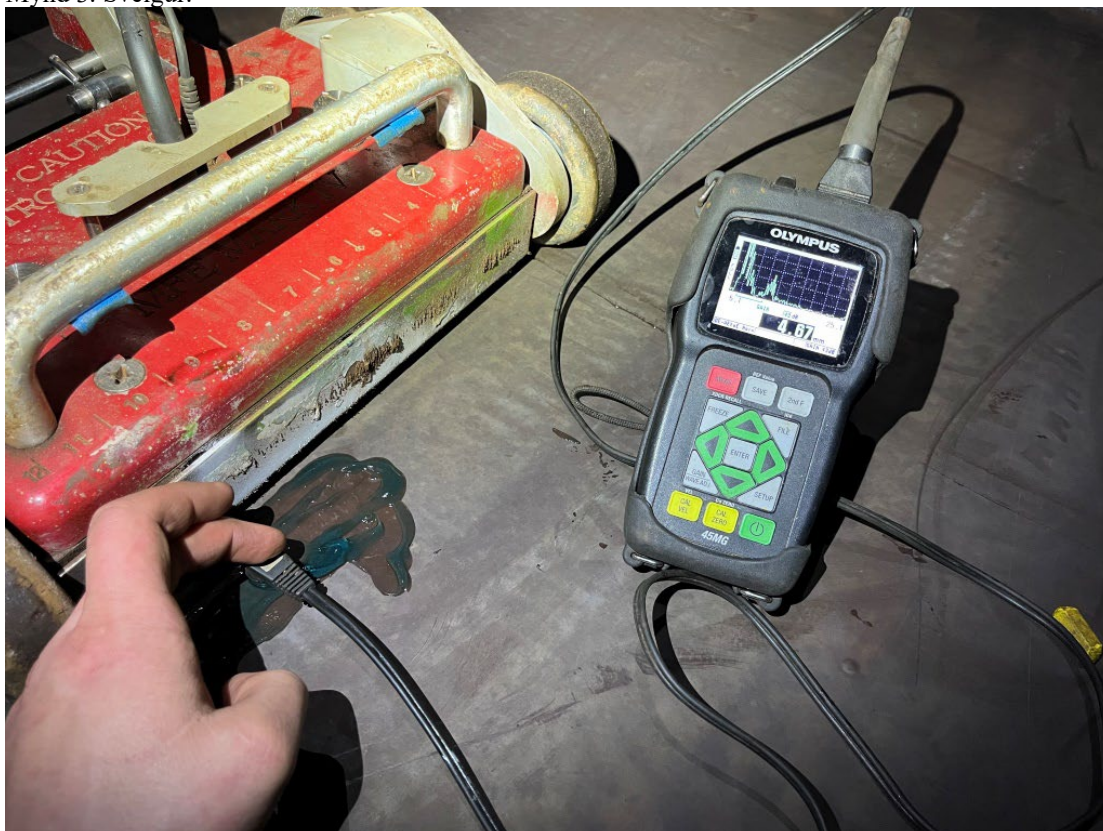
Mynd 4. Skanni fann þynningar í plötum 9-11 og 15. Mesta þynningin sýndi efnisþykkt plötu 4.67mm
